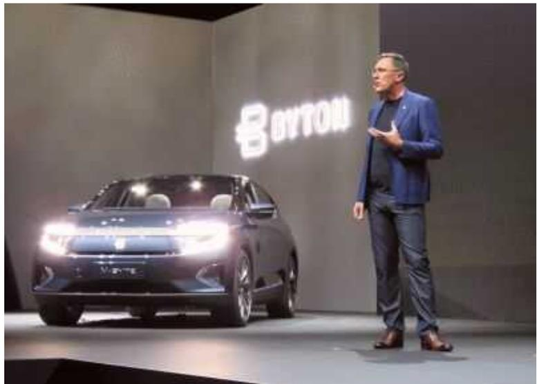
M-BYTE は、4875×1970×1665mm (全長×全幅×全高) のバッテリー駆動の EV。駆動方式は、1 モーター RWD(Rear-Wheel Drive: 後輪駆動車) の 200kW モデル、2 モーター 4WD の 300kW モデルがある。バッテリー容量は、95kW のモデルと 72kW のモデルがあり、4WD は 95kW の
